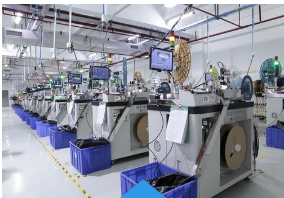
接触类弹片自动包装线
