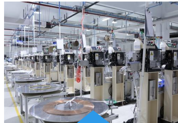
板对板连接器生产线
